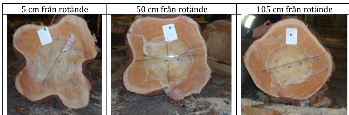
Figur 1. Diametermåtten i tallrotstockars rot del kan vara svåra att bestämma på grovt sågtimmer beroende på varierande barktjocklek och orundhet. Bilderna visar tvärsnitt på en stock på olika avstånd från rotändan.
