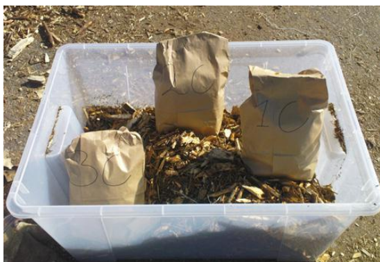
Figur 9. Generalprov innebär att material från ett antal provpunkter, 10 st i denna studie, samlas i en hink eller balja och blandas väl. Ur det blandade materialet tas sedan ett eller flera delprov. I denna studie togs tre delprov för att kunna analysera variationen inom generalprov.
