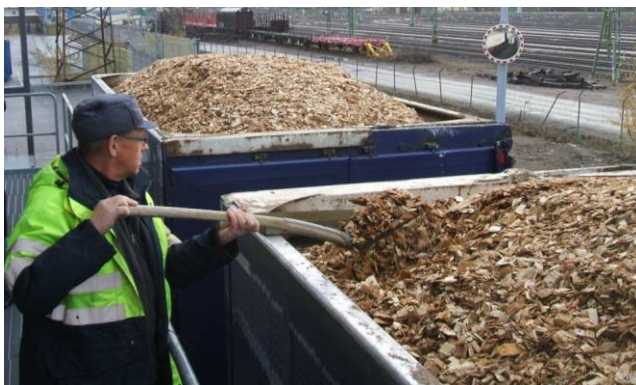
Figur 6. Provtagning med spade från mätbrygga
