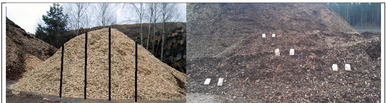
Figur 8. Uppdelning av lossad flis. Exempel på provpunkter.
