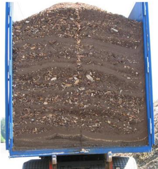
Figur 3. Exempel på skiktning i skäppa med bränsleflis (bild från finsk rapport)
