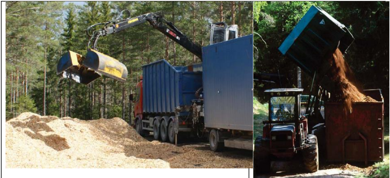
Figur 2. Den omrörning som skoplastning, eller tippning från en skäppa till en annan, innebär ger ett homogenare material. Foto: Skogforsk.
