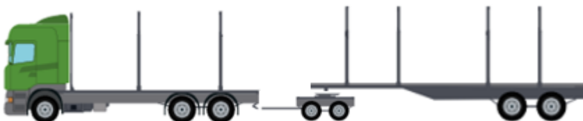
Figur 8: Timmerbil med dolly och trailersläp
