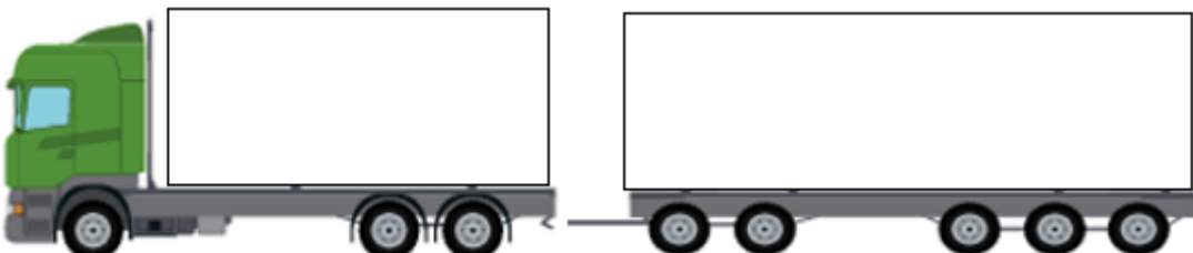
Figur 11: Huggbil med flisvagn
