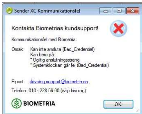
Figur 1 Meddelande som visas när Sender XC inte kan ansluta mot Biometria på grund av att klockan i maskindatorn går fel
