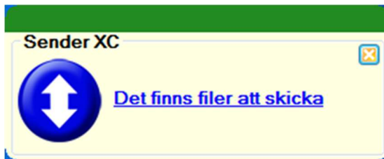
Figur 11 Med Sender XC inställd på manuell sändning indikerar meddelandet att Sender XC behöver öppnas för att skicka iväg filer som styrsystemet har skapat
