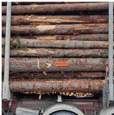
Signalskylt PROVTRAVE korrekt placerad på provtravens långsida
